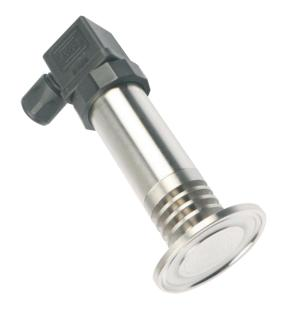
P6012 卫生型压力变送器是将膜片焊接到过程接口的最前端直接感知压力信号,以扩散硅芯片作为敏感元件,内置全数字处理电路将传感器毫伏信号转换成标准信号,广泛应用于食品、乳品、化工和制药等卫生型行业及测量介质可能结垢、堵塞场合的压力测量。
