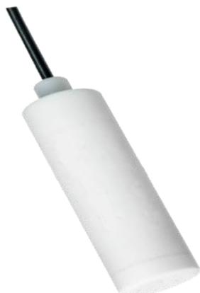
L6012 防腐型液位变送器专为强腐蚀液位测量设计，产品采用进口陶瓷电容传感器为敏感元件、外壳材质采用抗腐蚀性及强的 PTFE 材料，配合专用信号调理电路经过全方位线性误差和温度误差补偿，制成抗腐蚀性极强的压力液位测量产品。主要应用于自来水消毒用的氯气、化工、电池设备以及食品卫生等酸碱等腐蚀性介质的液位测量。
