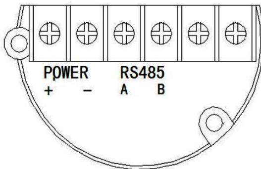
信号线可采用双绞线。在电磁干扰较严重的场合，建议使用屏蔽导线，并妥善接地。
